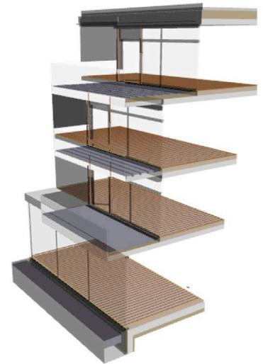
Abb. 1.: 3D Fassadenschnitt
